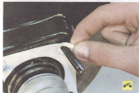
15. В случае замены вакуумного усилителя снимите со шпилек его крепления уплотнительную прокладку и установите на новый усилитель...
