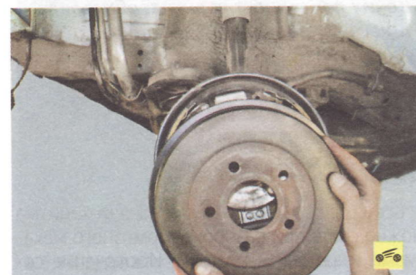
6. ...и снимите тормозной барабан.
