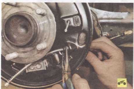
20. Сожмите пассатижами фиксаторы держателя удлинителя...
