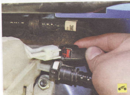
4. Отсоедините колодку от датчика уровня тормозной жидкости...
