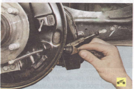
20. Сожмите пассатижами фиксаторы держателя удлинителя...
