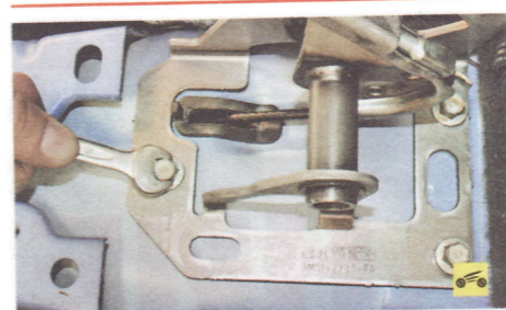
10. Выверните три болта крепления рычага привода стояночного тормоза к основанию кузова...
