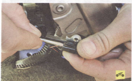
8. ...отожмите отверткой фиксатор колодки жгута проводов...
