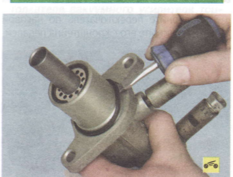
16. ...отверните две гайки крепления к усилителю главного тормозного цилиндра, снимите цилиндр и установите его на новый усилитель.
