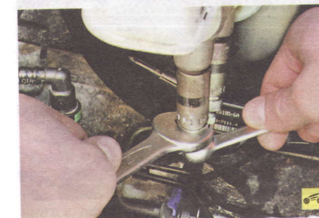
6. Отверните гайки крепления двух трубопроводов к регуляторам тормозных сил,
