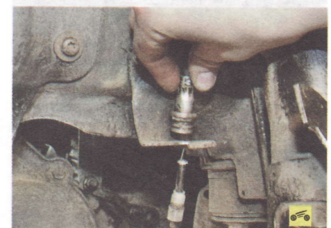
6. ...и извлеките наконечник шланга из отверстия кронштейна на кузове.
