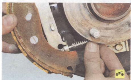
19. Отсоедините наконечник удлинителя троса от разжимного рычага стояночного тормоза.
