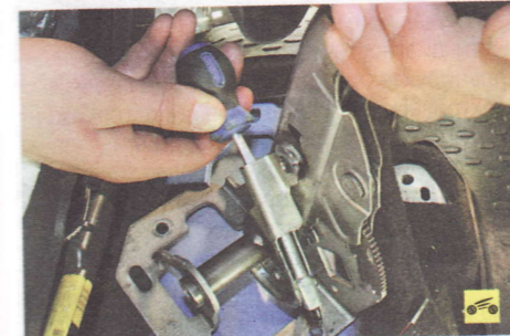
11. ...приподняв рычаг, вытолкните отверткой наконечник троса из направляющей в рычаге...
