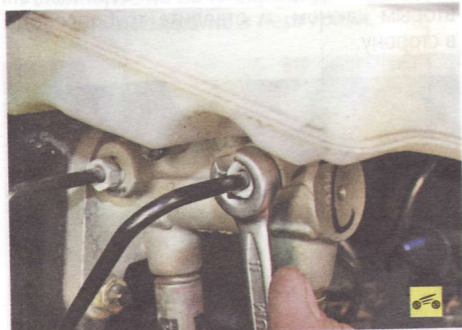
7. ...гайки крепления двух трубопроводов к главному тормозному цилиндру...
