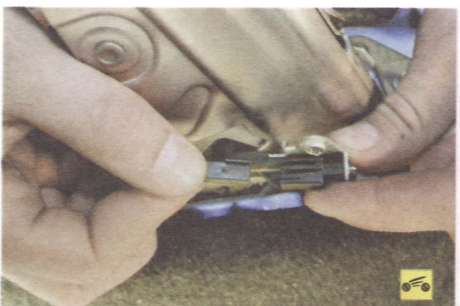
9. ...отсоедините колодку и снимите выключатель.
