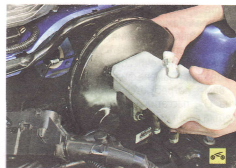
14. ...и снимите вакуумный усилитель в сборе с главным тормозным цилиндром.
