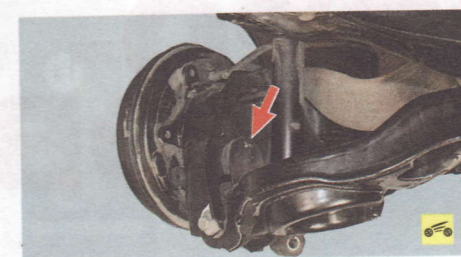
10. Выверните три болта крепления рычага привода стояночного тормоза к основанию кузова...
