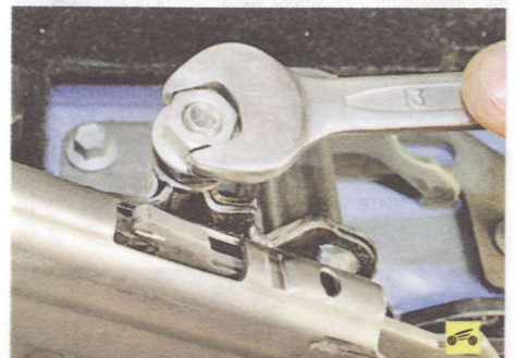
7. Выверните болт крепления выключателя сигнальной лампы состояния тормозной системы и включения стояночного тормоза к кронштейну рычага привода стояночного тормоза...
