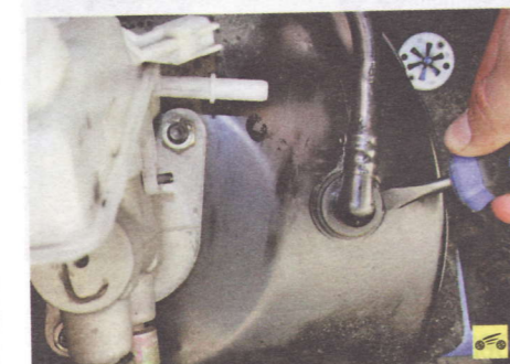
9. Поддев отверткой наконечник вакуумного шланга...
