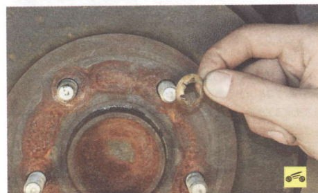
5. ...снимите с одной из шпилек фиксатор...
