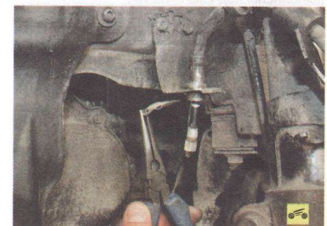
5. Снимите запорную скобу с верхнего наконечника шланга...
